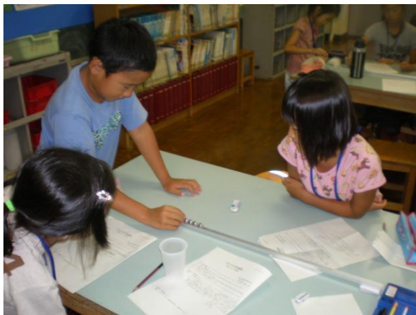
「ガウス加速器」の実験 アルミニウム製のレールの上に鋼球を並べて、衝突させます。
