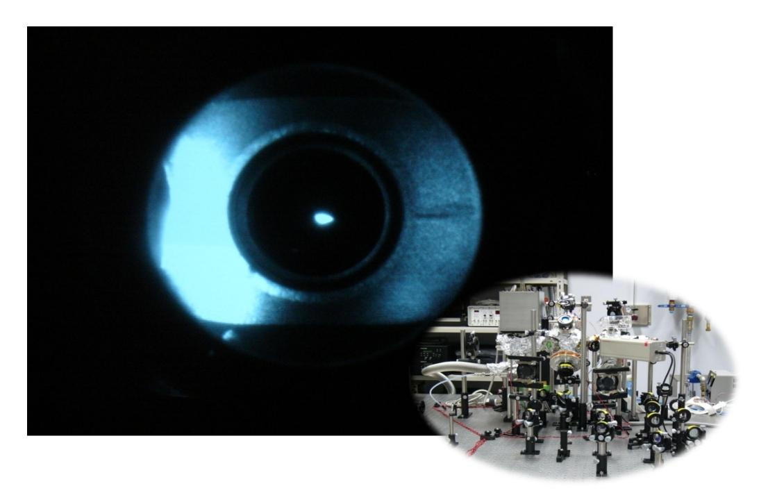
レーザー光で1ミリケルビン以下(約−273℃)まで冷却された原子からのレーザー誘起蛍光
